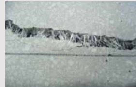
曲げ試験体のひび割れ面(繊維による引張抵抗)
